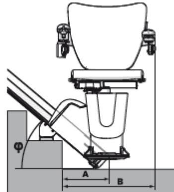
**ANCHURA FIJA DEL RIEL:** 160 mm (mín.) de la pared, 195 mm (mín.) con riel deslizante motorizado.
