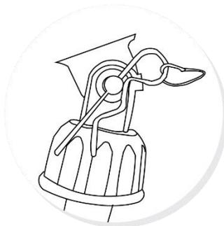
Asegúrese de que el pasador brazo-actuador esté sujetado con el pin de seguridad.
