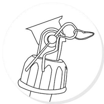
Asegúrese de que el pasador brazo-actuador esté sujeto con el pin de seguridad.
