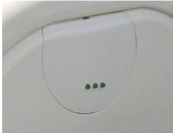
Fig. 6.1 - Indicador LED en la unidad de desplazamiento
