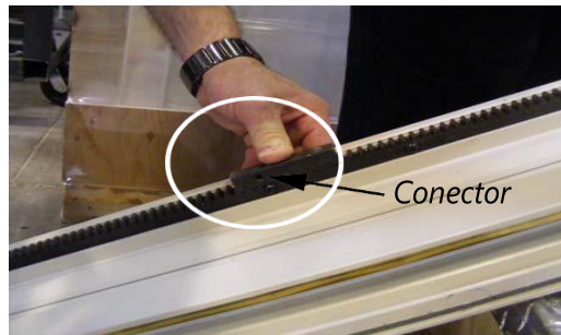
Fig. 5.18 - Conector de bastidor
