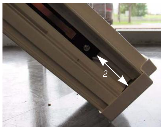
Fig. 5.7 - Introducir la tira de carga en el riel
