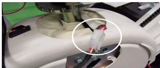
Fig. 5.24 - Conexión del asiento debajo del cierre de velcro
