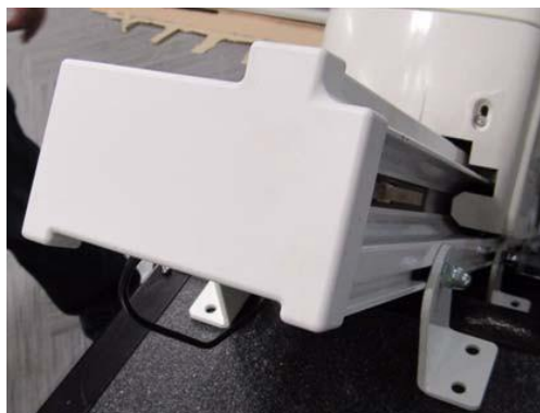
Fig. 5.26 - Instalación de la tapa del riel
