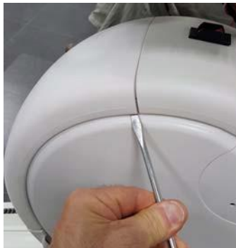
Fig. 5.17 - Retirar la cubierta
