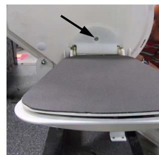
Fig. 5.28 - Retirar la cubierta
