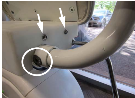
Fig. 5.27 - Tornillos de la cubierta de plástico
