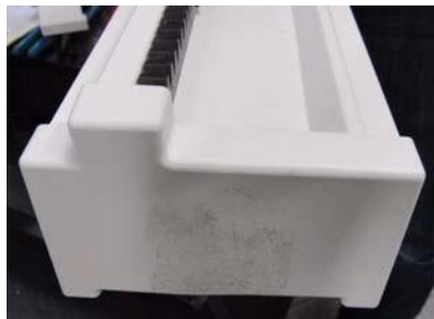
Fig. 5.9 - Montar la tapa de plástico del riel
